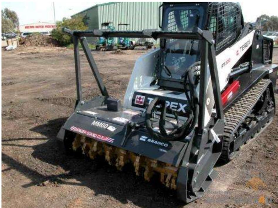
Благодаря высокотехнологичной конструкции шасси, машины TEREX (ASV) развивают скорость 18 км/ч и являются самыми скоростными мини-погрузчиками в мире. Наличие гусеничного движителя придаёт машине следующие преимущества: - высокая проходимость; - большое тяговое усилие; - лучшие устойчивость, управляемость и плавность хода; - низкое удельное давление на грунт. Возможен подъем рабочего мульчера до высоты 3 метра.
