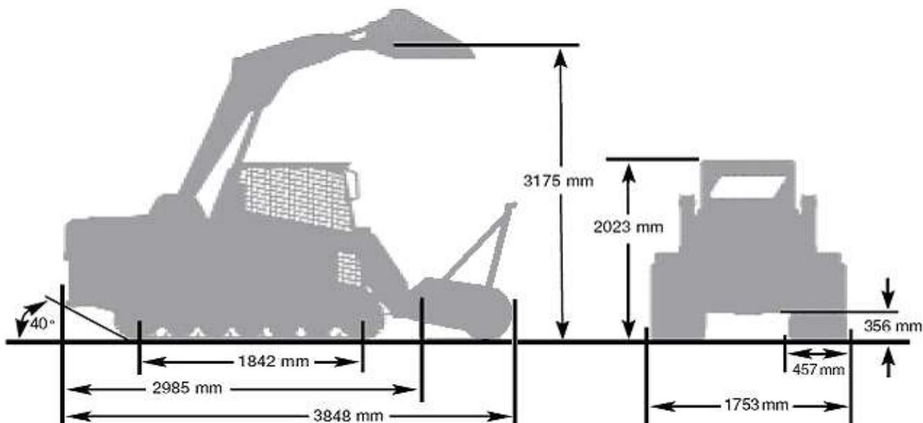
Машина оборудована мощным мульчером Magnum MM60S с 45-ю фиксированными двойными твёрдосплавными ножами, которые позволяют обрабатывать полосу шириной 60 дюймов (1524 мм). Он перерабатывает древесные стволы толщиной до 300 мм и может срезать пни диаметром до 400 мм на уровне земли. Расчистка территории способом измельчения с перемешиванием мульчи со слоем почвы.
