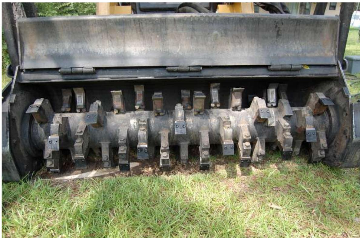
**На мульчере Magnum используются различные типы рабочих зубьев. Преимущественно используются высокопрочные высокоуглеродистые (карбидные) двухсторонние зубья с W-образным профилем.**
